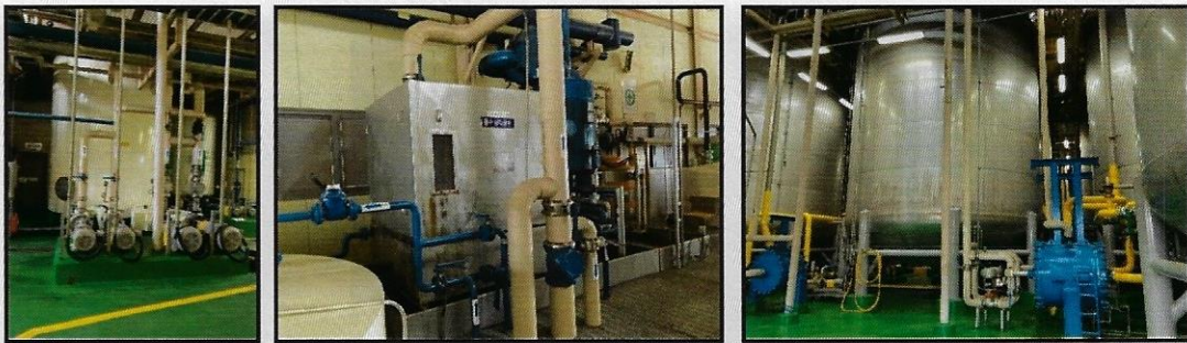
<그림9> 시험 구성 사진 (좌측부터 냉각수탱크 및 펌프, 냉각장치, 발효탱크)
